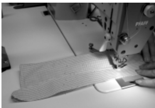
Der Kragensteg wird anschließend abgesteppt.
