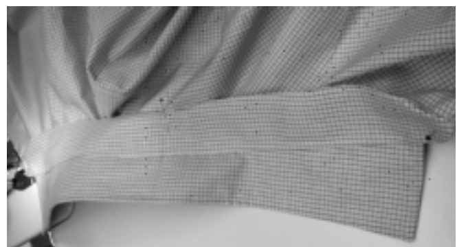
Der Kragen wurde von innen an das Hemd genäht. Die Stegkante wird umgebügelt und außen aufgesteppt.
