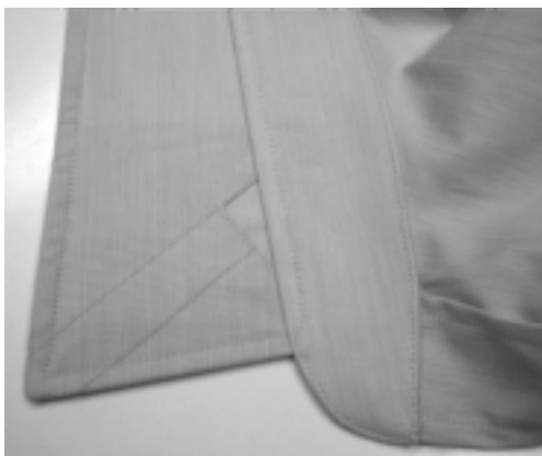
Der Einschub für die Stäbchen am Kragen kann auch unterlegt werden. Der Unterkragen bleibt somit flach.
